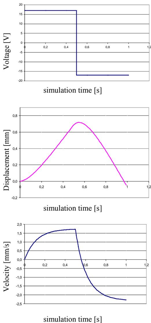
Fig. 8: Activation und motion of one drive
